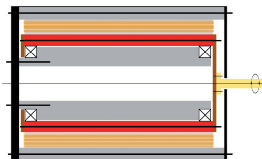
Рис. 1. Эскиз малоинерционного генератора МИГ на базе асинхронной машины
