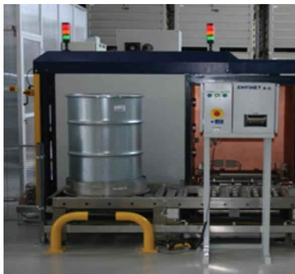
Рис. 2. Комплекс характеризации отходов GAMS-04
