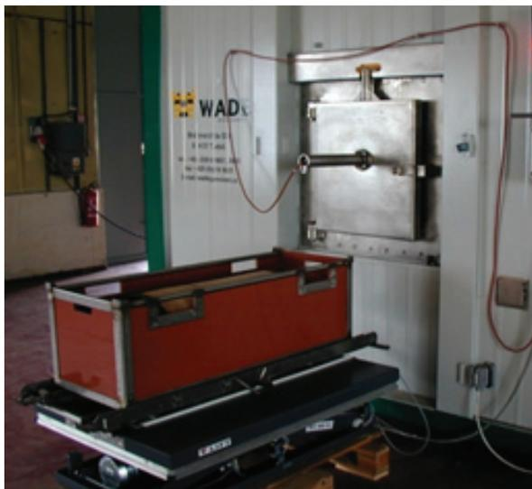
Рис. 1. Комплекс характеризации отходов MERLIN 1.03
