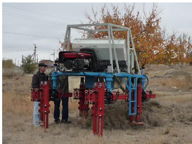
Шагающий робот «Ортоног»
