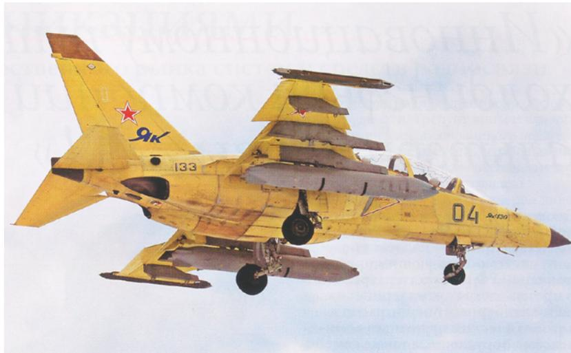
Рис. 1. Общий вид самолета Як-130УБС с установленными на подкрыльевых пилонах ПТБ [1]
