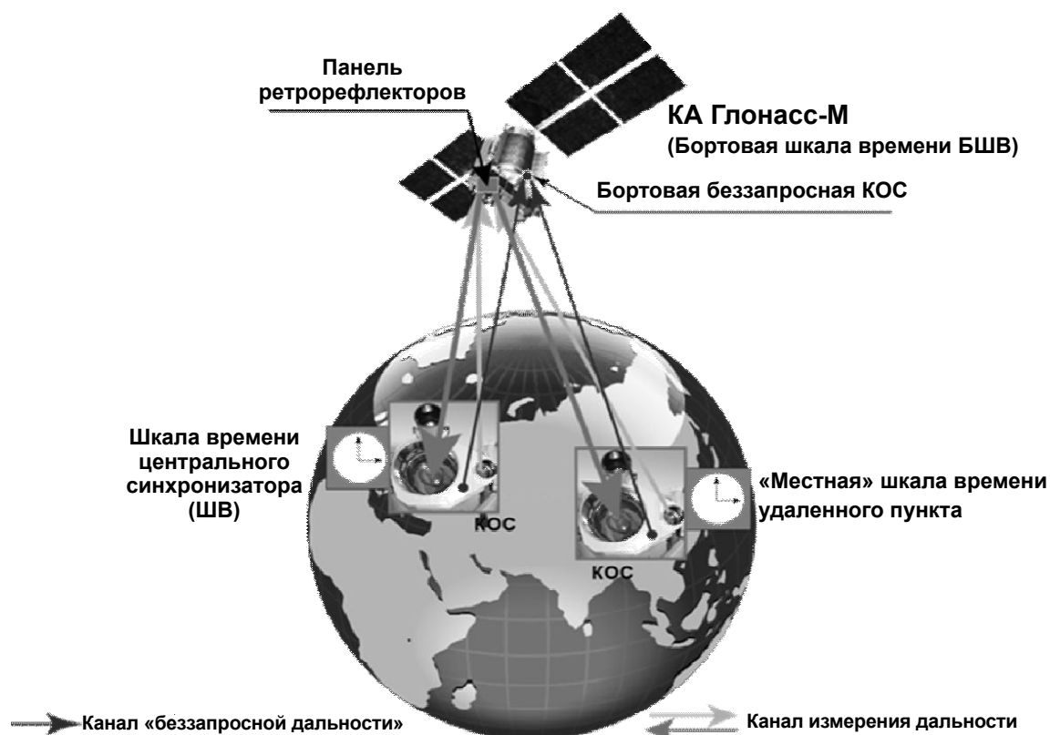
Рис. 3. Схема синхронизации БШВ-ШВ и передачи времени на удаленный наземный пункт с помощью беззапросной квантово-оптической системы
