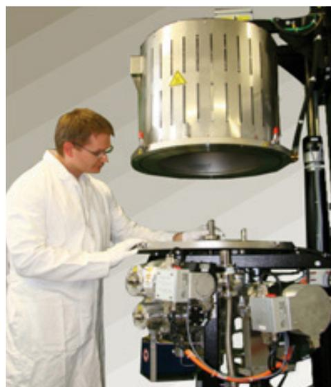
Рис. 2. Термовакуумная установка обезгаживания материалов и узлов (подборок)
