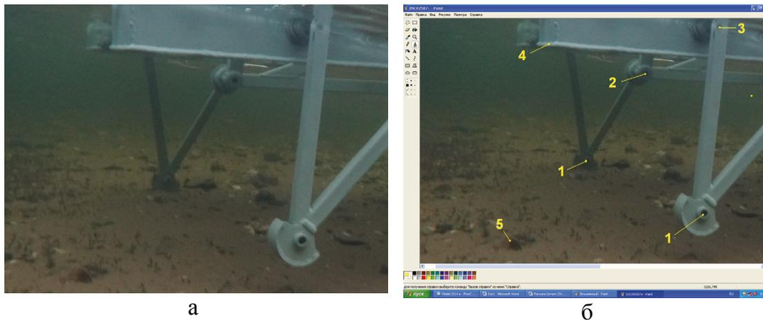
Рис. 5. Процесс движения (а) и кадровая обработка на ЭВМ видеозаписи процесса движения (б) подводного шагающего аппарата:
