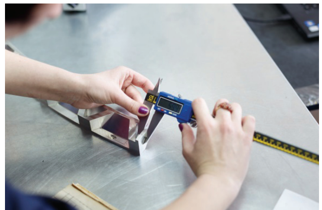
Рис. 5. Процесс производственного контроля изделий с помощью КИМ Romer и штангенциркуля
