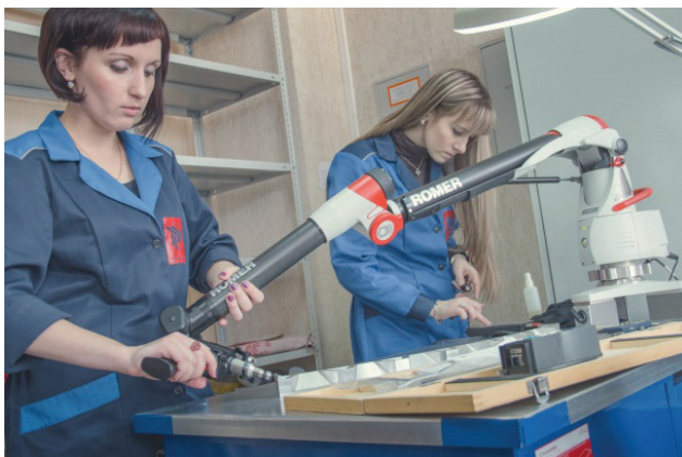
Рис. 5. Процесс производственного контроля изделий с помощью КИМ Romer и штангенциркуля
