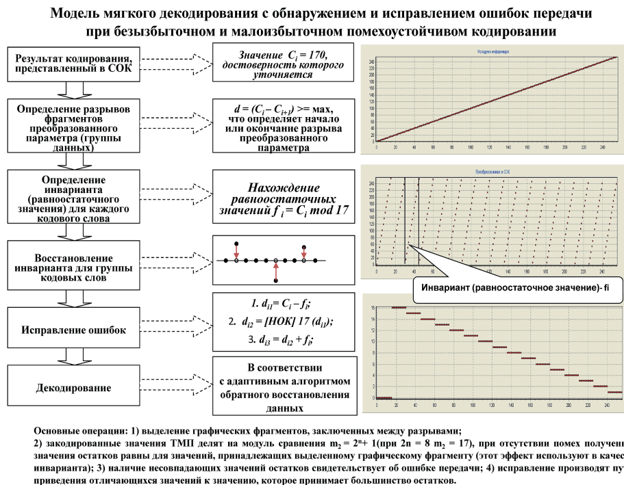
Рис. 2. Иллюстрация основных положений методики обнаружения и исправления ошибок передачи информации, осуществляемых за счет групповых свойств равноостаточности закодированных значений при наличии свойств внутренней избыточности передаваемых данных и сообщений
