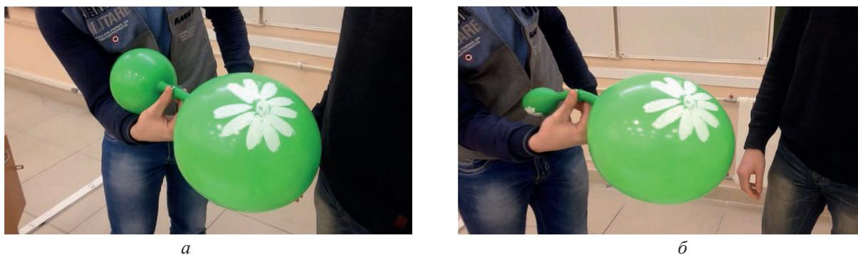
Рис. 4. Фотографии раздувания шарика большого диаметра шариком, который изначально имел меньший диаметр, но большее давление
