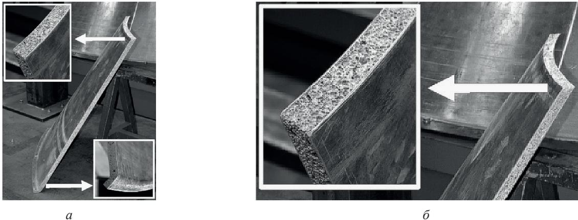
Рис. 1. Пеноалюминиевый сегмент: а – общий вид; б – увеличенный фрагмент [1]
