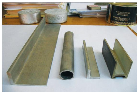
Рис. 6. Типичные профили с волокнистой структурой, отпрессованные из алюминиевого деформируемого сплава Д1 и нанопорошка нитрида титана TiN. Для оценки размеров профилей – см. в левом верхнем углу фотографии – показаны две цилиндрические технологические пробы  $\varnothing 72 \text{ мм}$
