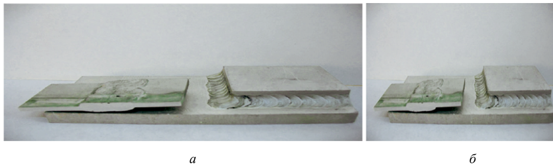
Рис. 3. Фрагменты сварки листовой конструкции из листов сплава АМг6 толщиной 5,0 мм (а) и 8,0 мм (б) электродом, содержащим нанопорошок карбонитрида титана TiCN
