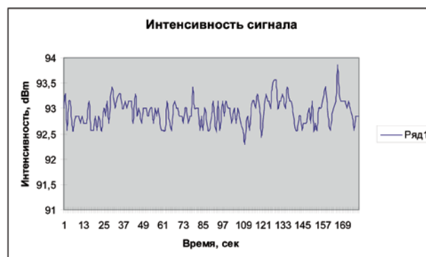
Рис. 7. Изменение интенсивности сигнала системы радиодоступа для стационарного абонента
