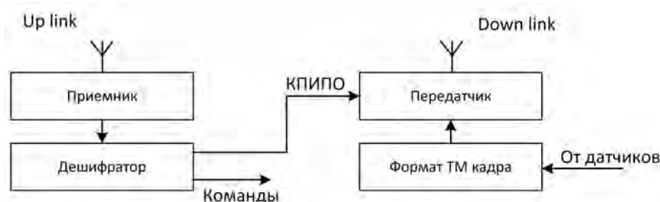
Рис. 1. Обобщенная структурная схема КИС КА
