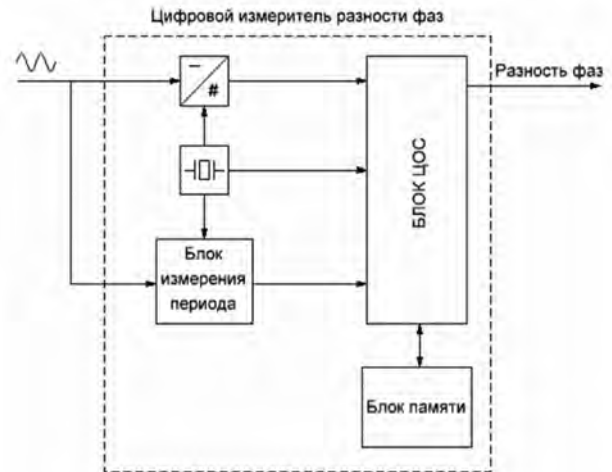
Рис. 7. Цифровой измеритель разности фаз при разновременном приеме сигналов
