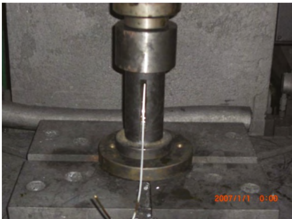
Рис. 1. Экструдирование проволоки с помощью пресса
