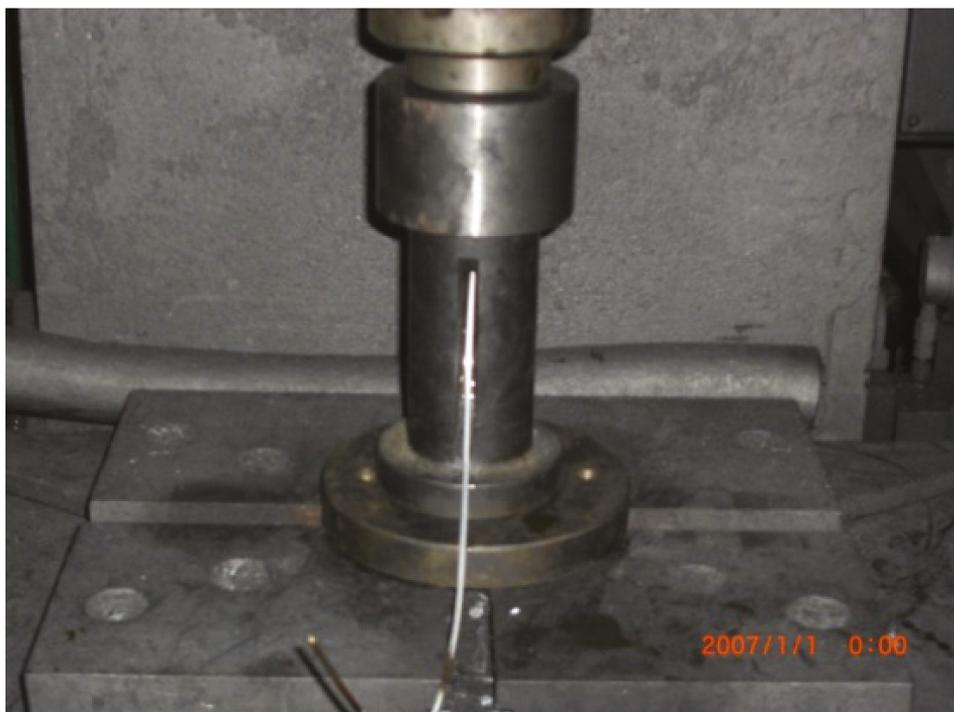
Рис. 1. Экструдирование проволоки с помощью пресса
