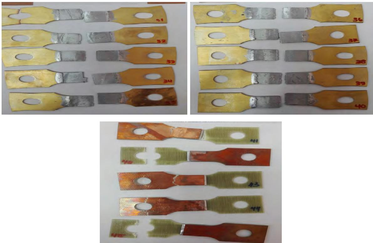
Рис. 2. Разрушенные образцы после УКИ и ТЦ
