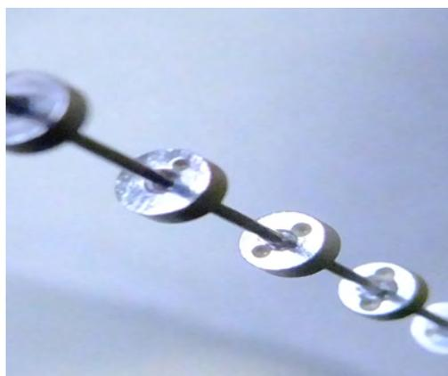
Рис. 4. Паяемые детали проводник, шайбы
