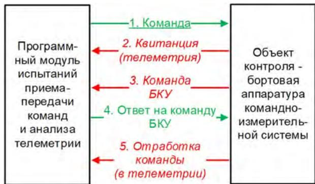
Рис. 1. Поток данных при испытаниях приема-передачи команд
