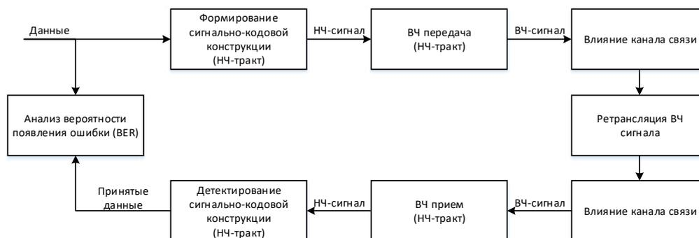
Рис. 5. Структурная схема компьютерной модели для оценки влияния параметров БРК на сигнал
