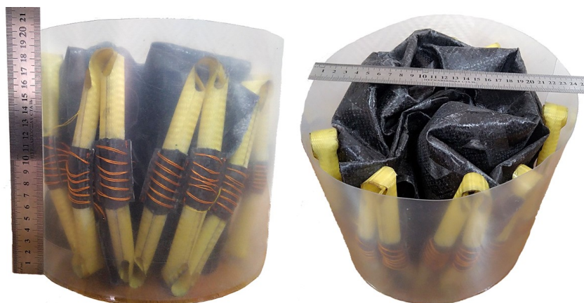
Рис. 26. Рефлектор в транспортировочном положении
