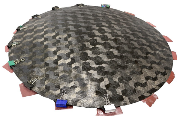
Рис. 21. Готовая мембрана из углепластиковых лент, закрепленная на заготовке
