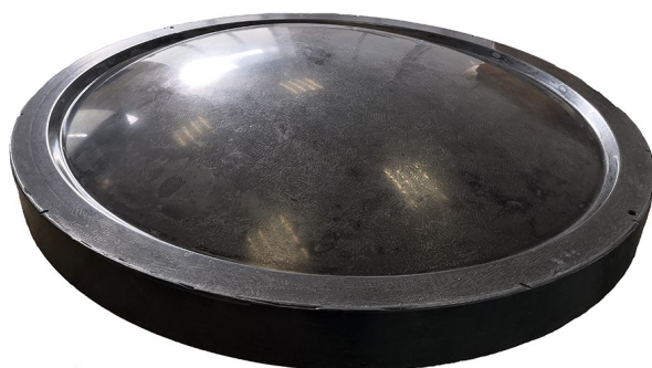
Рис. 20. Литая заготовка для формования мембраны рефлектора
