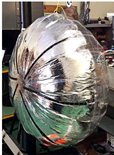
Рис. 6. Надувная антенна для платформы CubeSat
