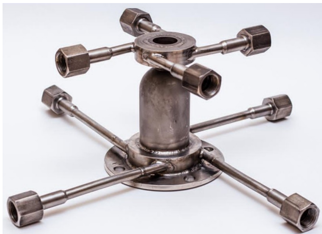
Рис. 7. Экспериментальная КС с присоединенными коллекторами подвода
