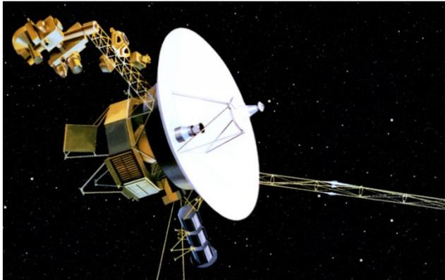
Рис. 3. Композитный рефлектор антенны космического аппарата Voyager
