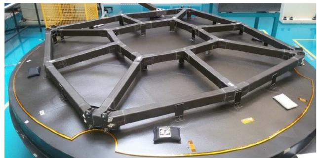
Рис. 12. Рефлектор с композитной рамой
