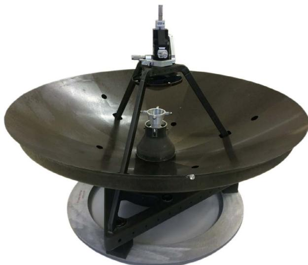
Рис. 27. Антенна, состоящая из двух тонких композитных оболочек
