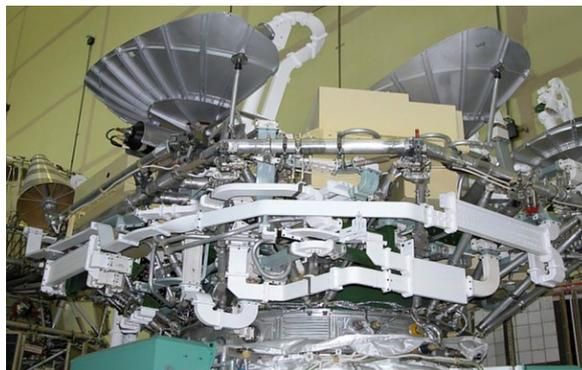
Рис. 2. Антенны на космическом аппарате герметичного исполнения
