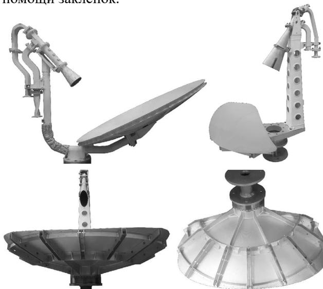
Рис. 1. Металлические зеркальные антенны космических аппаратов
