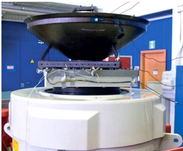
Рис. 31. Антенна на вертикальном вибростенде
