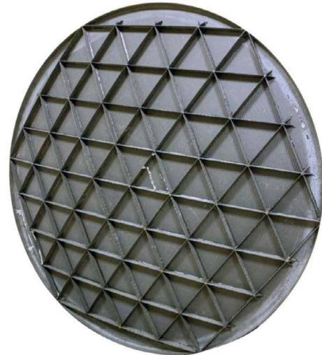
Рис. 29. Рефлектор с изогридным подкреплением
