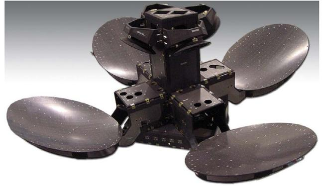
Рис. 19. Блок двухзеркальных антенн
