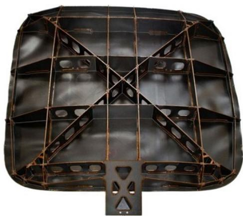
Рис. 13. Рефлектор с ребрами из сотовых панелей
