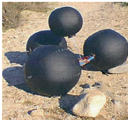
Рис. 35. Прототип марсохода, использующий надувную систему развертывания солнечной батареи
