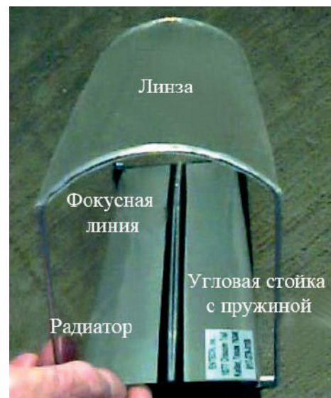
Рис. 40. Принцип работы концентратора батареи SCARLET
