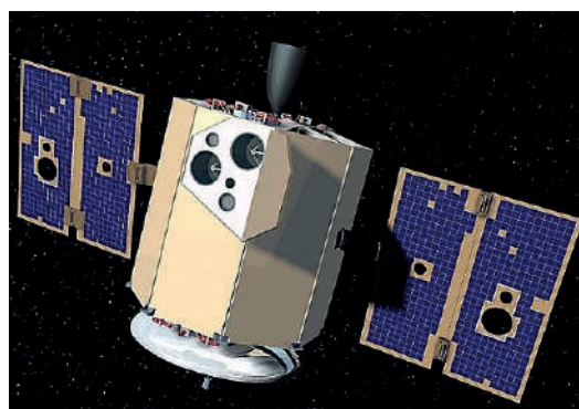
Рис. 15. Крыло солнечной батареи Clementine и его расположение на космическом аппарате
