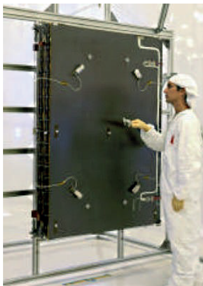
Рис. 43. Крыло солнечной батареи космического аппарата DS1 в свернутом для перевозки виде
