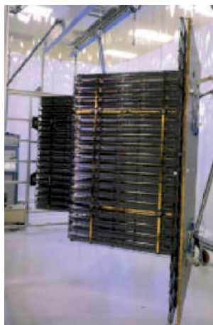
Рис. 44. Крыло солнечной батареи космического аппарата DS1 в процессе раскрытия
