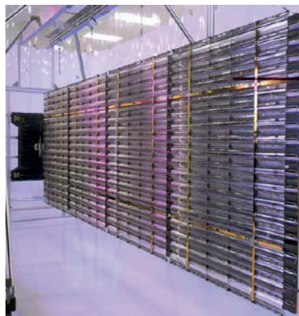
Рис. 45. Крыло солнечной батареи космического аппарата DS1 полностью развернутое
