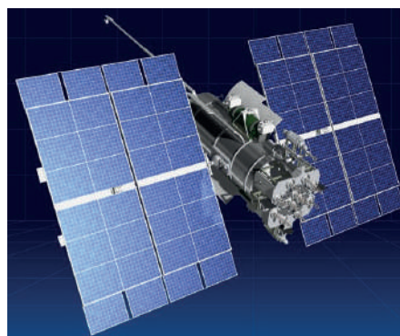
Рис. 7. Космический аппарат «Глонасс» с раскладываемой многопанельной солнечной батареей
