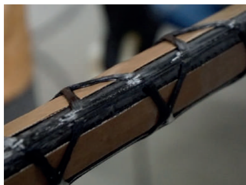
Рис. 4. Изготовление трубы с треугольным сечением
