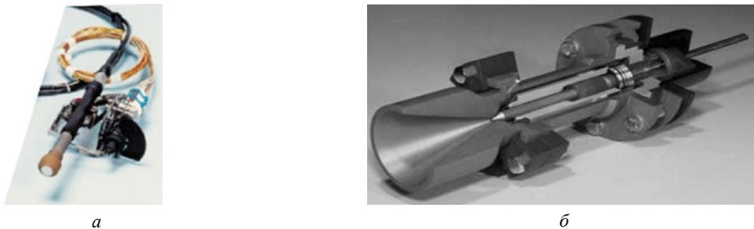
Рис. 2. Электротермические двигатели:
