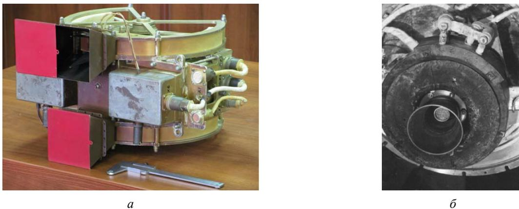
Рис. 4. ЭРДУ импульсного и магнитоплазодинамического типов:
