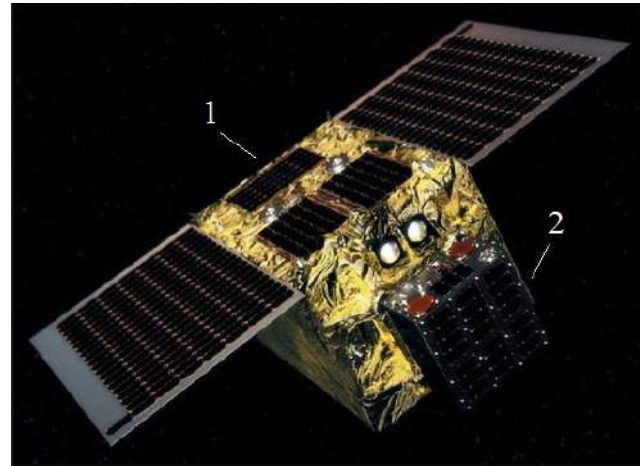
Рис. 2. Сборка КА «ELSA-d»: «Chaser» (1) с прикрепленным спутником «Target» (2)
