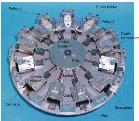
Рис. 6. Принципиальная схема и макет втулки с подвижным закреплением спиц [5]
