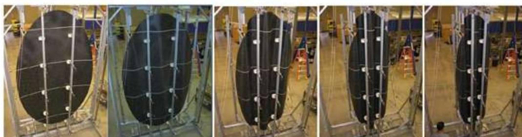
Рис. 17. Конструкция мембранного рефлектора с ребрами жесткости TEMBO [11]
