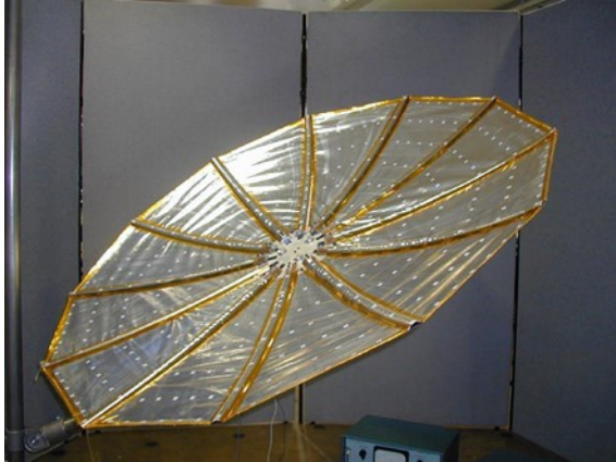
Рис. 5. Модель раскрываемого рефлектора диаметром 1,5 м [5]
