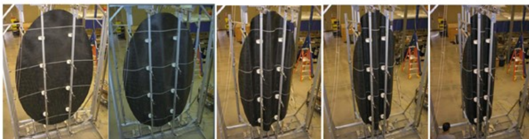
Рис. 17. Конструкция мембранного рефлектора с ребрами жесткости TEMBO [11]
