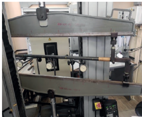
Рис. 6. Схема испытаний образцов на изгиб: 1 – неподвижная траверса испытательной машины; 2 – подвижная траверса испытательной машины; 3, 4 – штанга; 5 – тяга; 6 – образец; 7 – гайка; 8 – часовые индикатор на магнитных стойках
