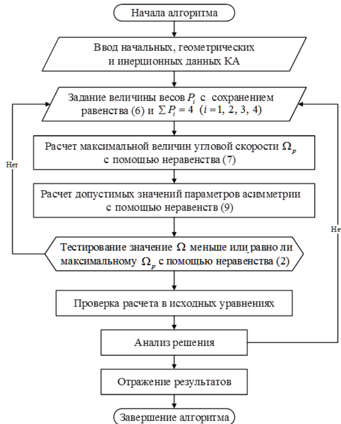
Рис. 1. Алгоритм установления допустимых значений переменных малой массовой асимметрии, как и малой инерционной асимметрии
