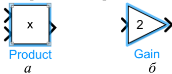
Рис. 12. Составной блок ФД: а – аналогового умножения сигналов Product, б – усиления сигнала Gain
