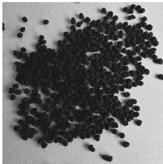
Рисунок 1. Общий вид гранул катализатора разложения гидразина
