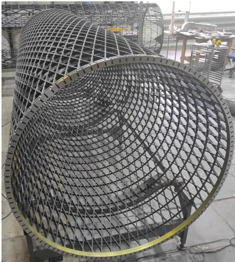
Рисунок 1. Сетчатая анизотридная конструкция
