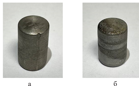
а Рисунок 10. Внешний вид эмиттера: а — до стендовых испытаний; б — после стендовых испытаний
