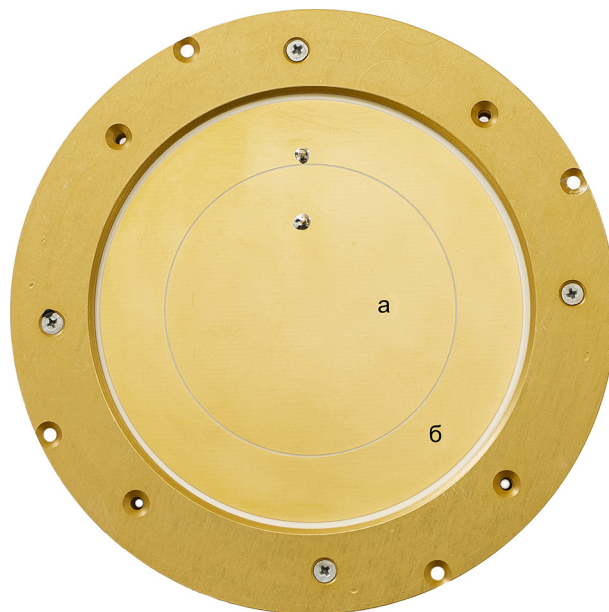
Рисунок 13. Зонд Ленгмюра: коллектор (а) и охранный кольцо (б), макет
